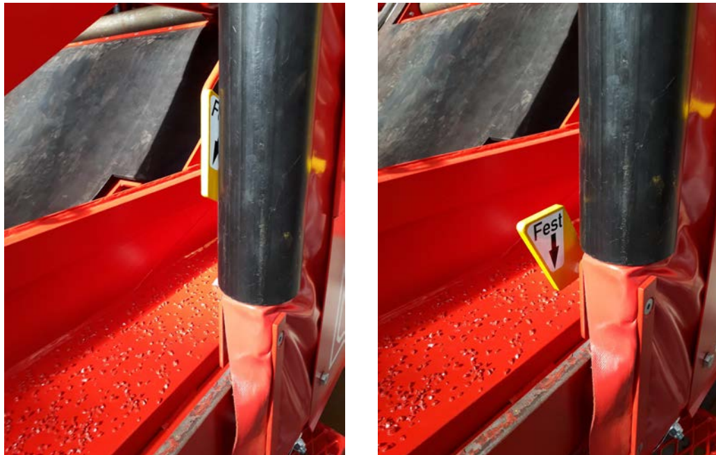
Bild 4 Offene und geschlossen Position der Planenbremse
