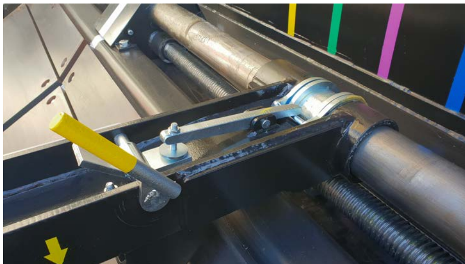
Bild 7 Hebel ist nicht in Position „Verriegelt“, kein Kontakt mit Hebeln
