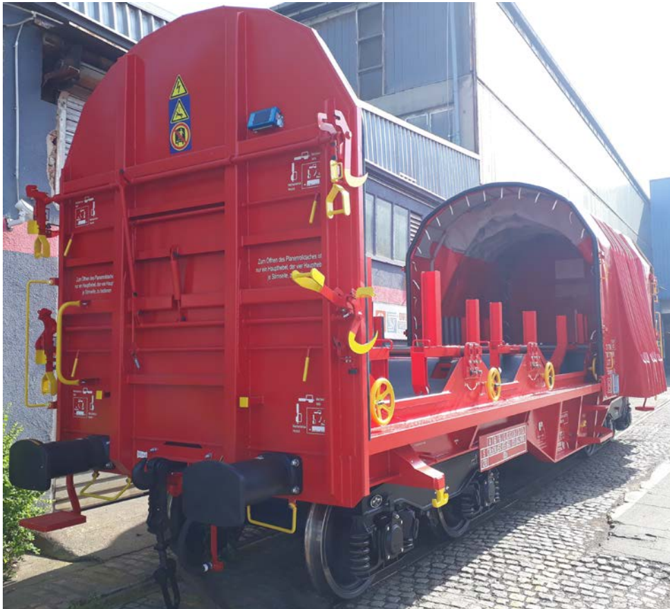
Bild 3 Offene Position der Plane
